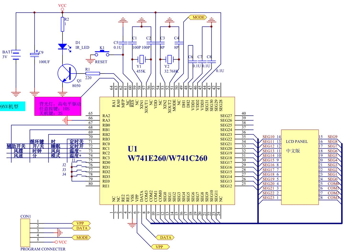
RA3=GND: 表示IC工作于09NV机型
